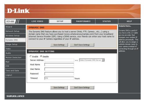
**DDNS:** El servidor de nombre de dominio dinámico tendrá un nombre de host DNS y sincronizará la dirección IP pública del módem cuando se haya modificado. Se debe especificar el nombre de usuario y la contraseña para utilizar el servicio DDNS.
