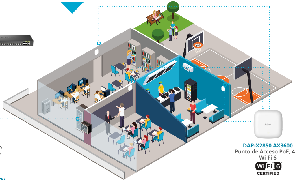
DGS-1210-52MP Smart Managed Max PoE Acceso a los puntos de acceso Wi-Fi. Enlace por fibra al core
